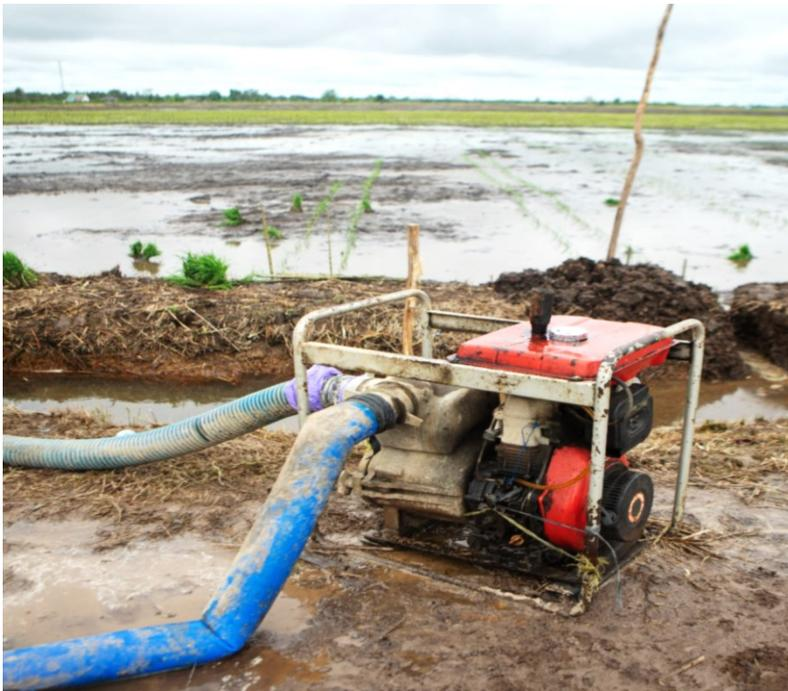
**Gambar 4.3. Pengambilan/pengangkatan air ke permukaan tanah dengan pompa**
